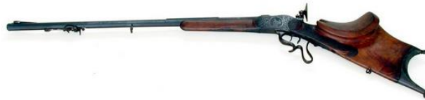
Zimmerstutzen der Oberfinninger Hubertusschützen -- Hergestellt um 1910 von J. Greger, Dillingen, cal. 4,6 mm -- Stiegele-Verschluß. Schäftung mit Tiroler Backe, Verschneidung mit Fischhautmuster. Abzug mit Stecher, Abzugsbügel mehrfach geschwungen. Diopter -- Ausgestellt im Schwäbischen Schützenmuseum Illerbeuren
